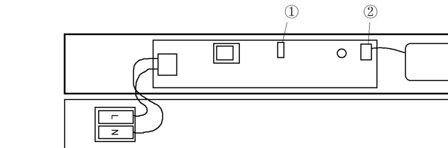
1. Rimuovere il connettore a 2 pin per il funzionamento in modalità interrotta.
