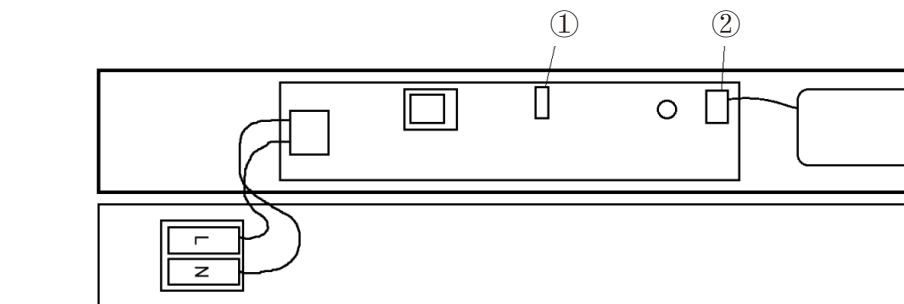
1. Retire o conector de 2 pernos para operação intermitente.
