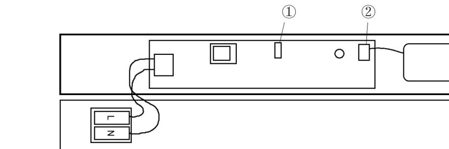
1. Retire el conector de 2 corchetes para el modo de funcionamiento intermitente.
