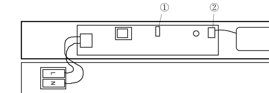
1. Αφαιρέστε το συνδετήρα δύο πινέζων για συνεχή λειτουργία.
